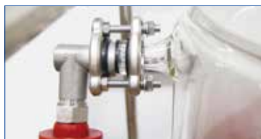
① Heated Fluid In-Out Flat Flange (od φ35×id φ18mm) & Metal Clamp
